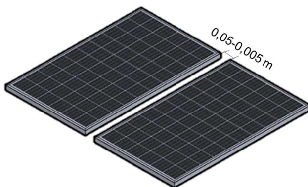
Figura 51. Distanza media tra i moduli fotovoltaici
