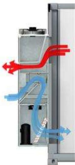
*Figura 33. Esempio di un sistema free-cooling diretto*
