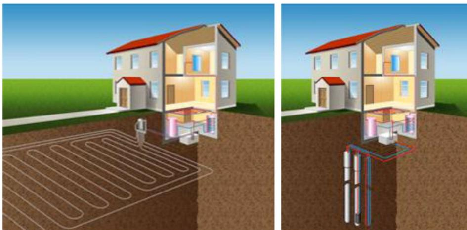
Figura 18. Pompa di calore a terreno con sonde orizzontali (a sinistra) e verticali (a destra)
