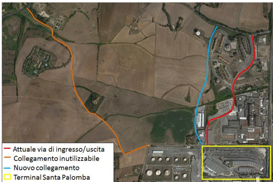
Figura 13 L'accessibilità stradale al terminal di Santa Palomba.
