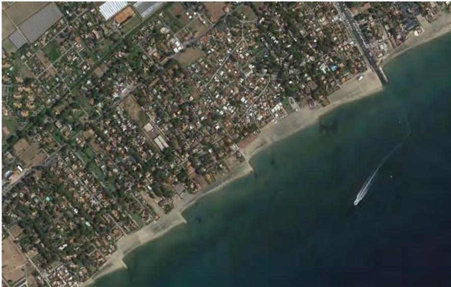
Figura 8-45 Pennelli posti in prossimità della foce di Fiume Sisto. Dalla conformazione a dente di sega della liena di riva prodotta dai pennelli si evince che il trasporto solido è diretto da sud-ovest verso nord-est.
