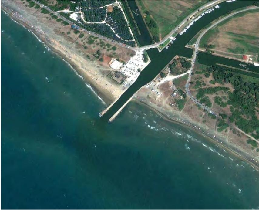
Figura 8-38 Vecchia armatura della foce del Canale di Rio Martino realizzata con moli paralleli rettilinei
