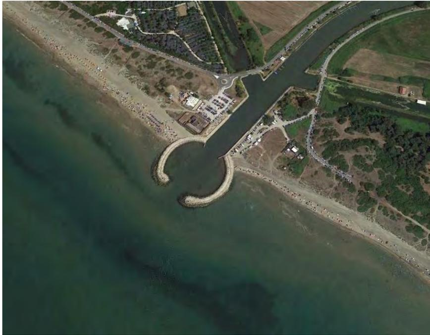
Figura 8-37 Nuova armatura della foce del Canale di Rio Martino realizzata mediante moli a forma circolare
