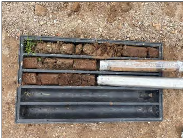
FOTO 4 – Prelievo terreni e campioni in S1C1 – 0.00 – 3.00m
