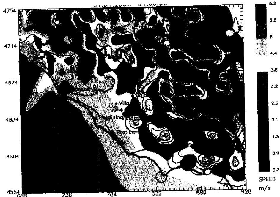
Figura 3.22 - Campo di velocità media annuale del vento a 200 m di quota sul dominio del Lazio. Valori in m/s secondo la scala colorata riportata a destra.
