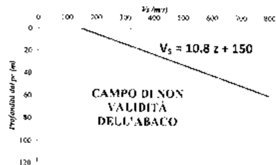
Fig. 5: Abaco per le Argille e Limi con gradiente di velocità minimo
