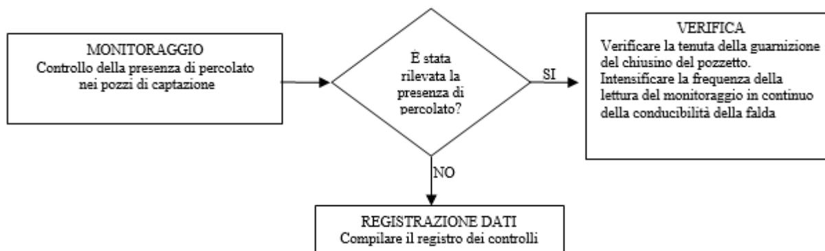
Il monitoraggio sarà mantenuto anche dopo l'esaurimento della produzione di percolato, per verificare l'integrità del sistema di impermeabilizzazione di copertura:
