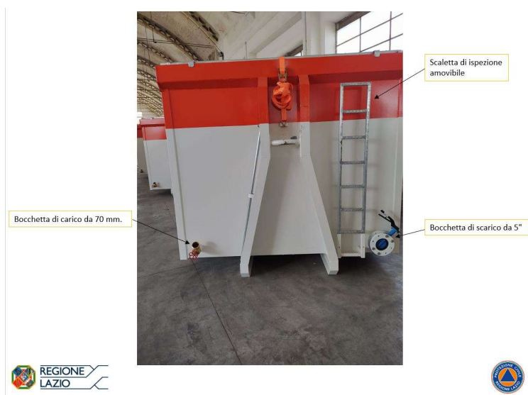
Container ultimato e pronto all'impiego
