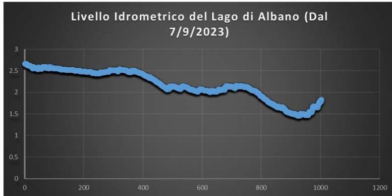
Figura 2 – evoluzione del livello idrometrico del Lago di Albano a partire dal 7/9/2023. In ordinate il livello in metri, in ascisse il numero dei giorni dalla data di installazione.
