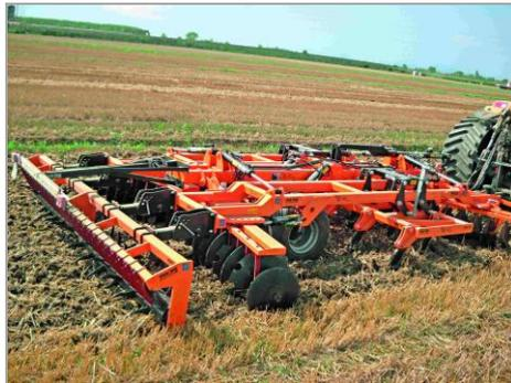
Figura 7 – Esempio di coltivatore combinato
