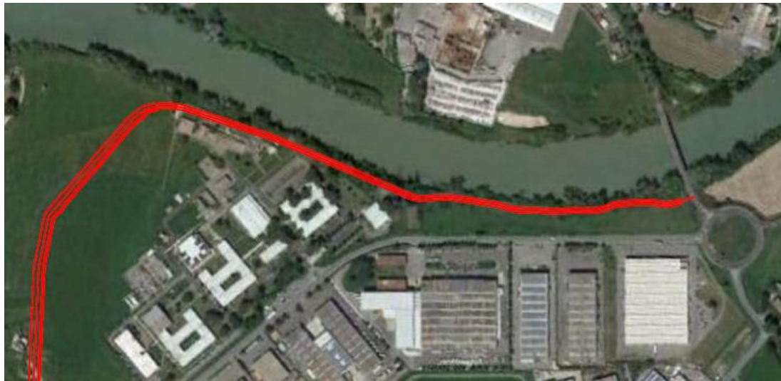
Figura 25: Stralcio della planimetria su ortofoto relativamente alla nuova (3°) ipotesi progettuale del tracciato arginale (Monterotondo Scalo).
