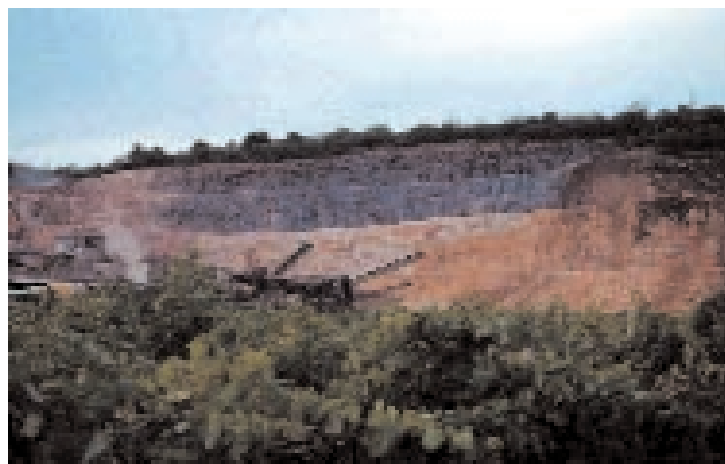
Foto 16.14 - Intervento di inscurimento con sostanze ossidanti, cava San Lorenzo, Soav e (VR), 1993 Foto: G. Sauli
