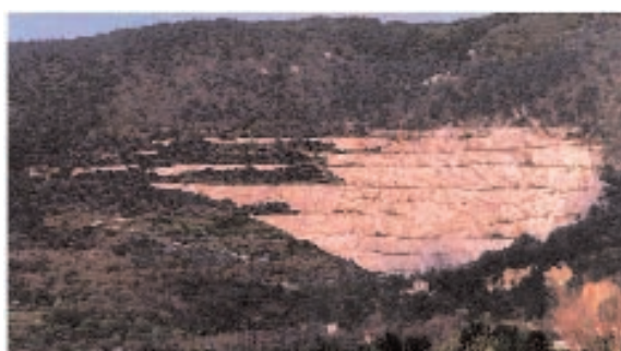
Foto 17.19 - Progetto per collocazione a discarica di inerti di scarto e contemporanea ricomposizione morfologica parziale dell'ex cava Faccanoni (foto-montaggio).
