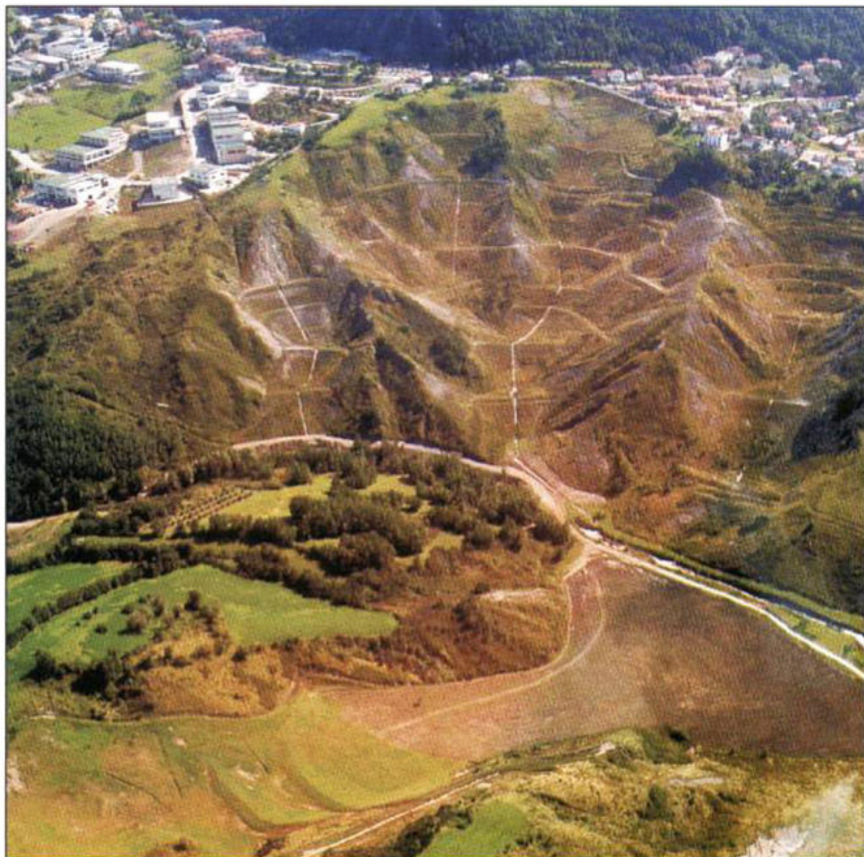
Foto 18: Calanchi di San Marino: vista frontale della bonifica del bacino di Fosso del Re dopo l'idrosermina (Ottobre 2002) - Foto Archivi Dipartimento Territorio e Ambiente.
