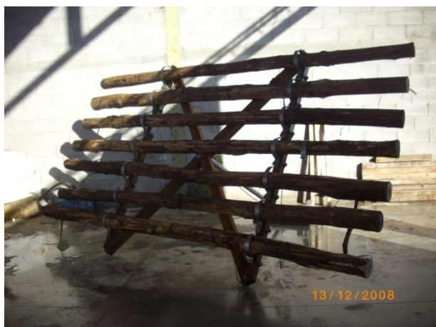
Figura 16. Struttura in acciaio a croce di Sant'Andrea. Figura 17. Tirante centrale metallico e funi. (JemmBuild s.r.l.)
