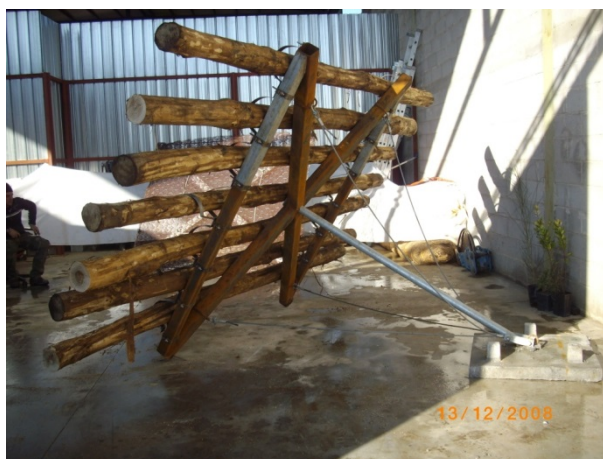
Figura 16. Struttura in acciaio a croce di Sant'Andrea. Figura 17. Tirante centrale metallico e funi. (JemmBuild s.r.l.)
