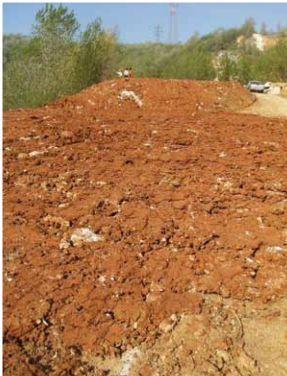
Fig. E1 Sito per l'esperimento di rinaturazione nella cava dismessa "Ex Sgotti - Cava alta". Il substrato utilizzato, caratterizzato secondo la normativa vigente, presentava tessitura argillosa, un elevato contenuto di carbonati e calcio, e una forte carenza di nutrienti. Foto: F. Gilardelli
