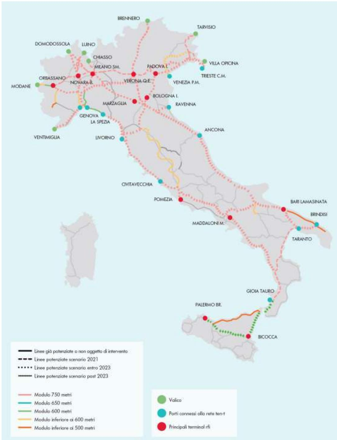
Figura 27 Moduli della rete ferroviaria italiana secondo il Piano Industriale di RFI. Fonte: RFI 2020.
