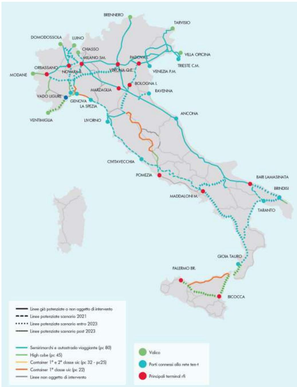
Figura 26 Sagome della rete ferroviaria italiana secondo il piano industriale di RFI. Fonte RFI 2020.
