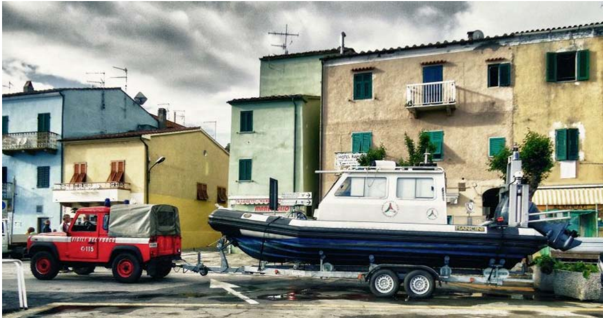
Fig. 1 Imbarcazione idrografica Mancini 7.5 DPC dedicata ai rilievi idrografici ad alta risoluzione
