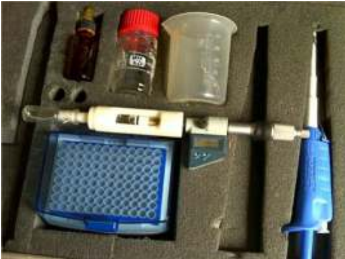
Fig. 4 – Microburetta portatile per la determinazione in campo dell'alcalinità
