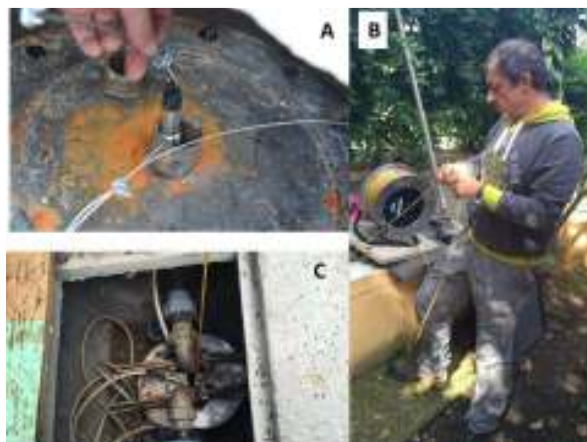
Fig. 2 – A) Installazione del diver per la misura in continuo del livello piezometrico. B) e C) Misura del livello piezometrico tramite freaticometro
