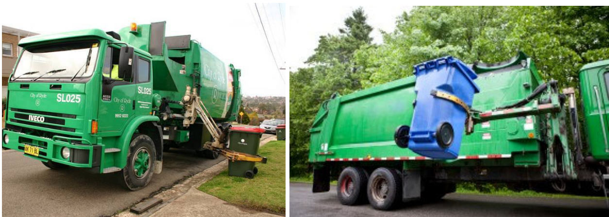
Figura 9 Sistemi di svuotamento semiautomatico di bidoni carrellati utilizzati in Australia e Stati Uniti
