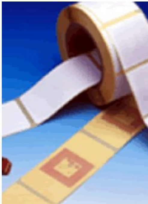
Figura 20: Illustrazione delle etichette adesive dotate di trasponder passivo (RFID TAG)
