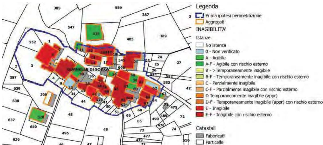
Figura 8 - Livello di Inagibilità degli edifici (schede AEDES) – Cornelle di sotto
