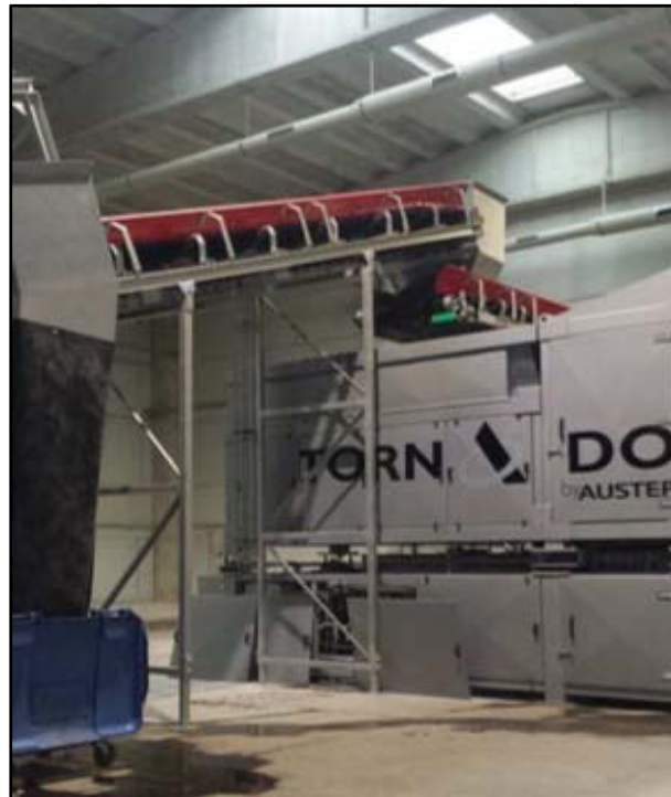
Figura 31 – Spremitrice "Tornado" prevista per l'installazione
