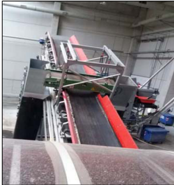
Figura 30 – Separatore Magnetico previsto per l'installazione
