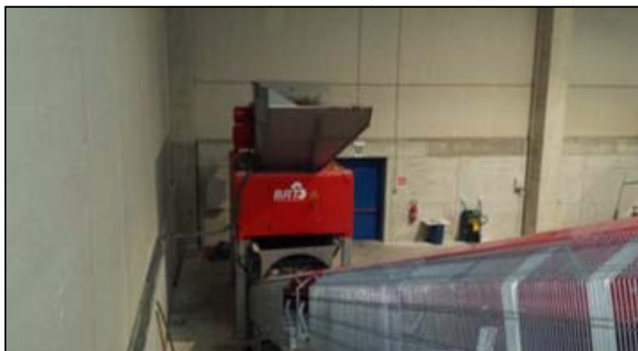
Figura 29 – Apri-sacchi prevista per l'installazione
