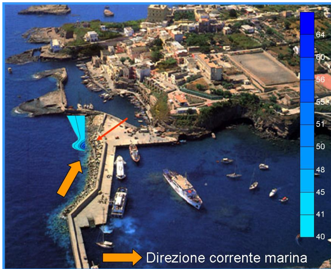
Fig.10 Ipotesi di diffusione e diluizione orizzontale dello scarico di acqua sovrassalata con correnti marine prevalenti da nord verso sud.
