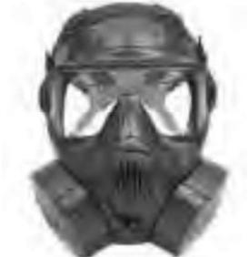
Maschera a pieno facciale ad un filtro a raccordo normalizzato EN 148. Forma anatomica con struttura in elastomerico ipoallergenico. Schermo in policarbonato antiappannamento resistente a graffi e urti secondo la norma EN 166 2001: resistenza B; campo 5.
